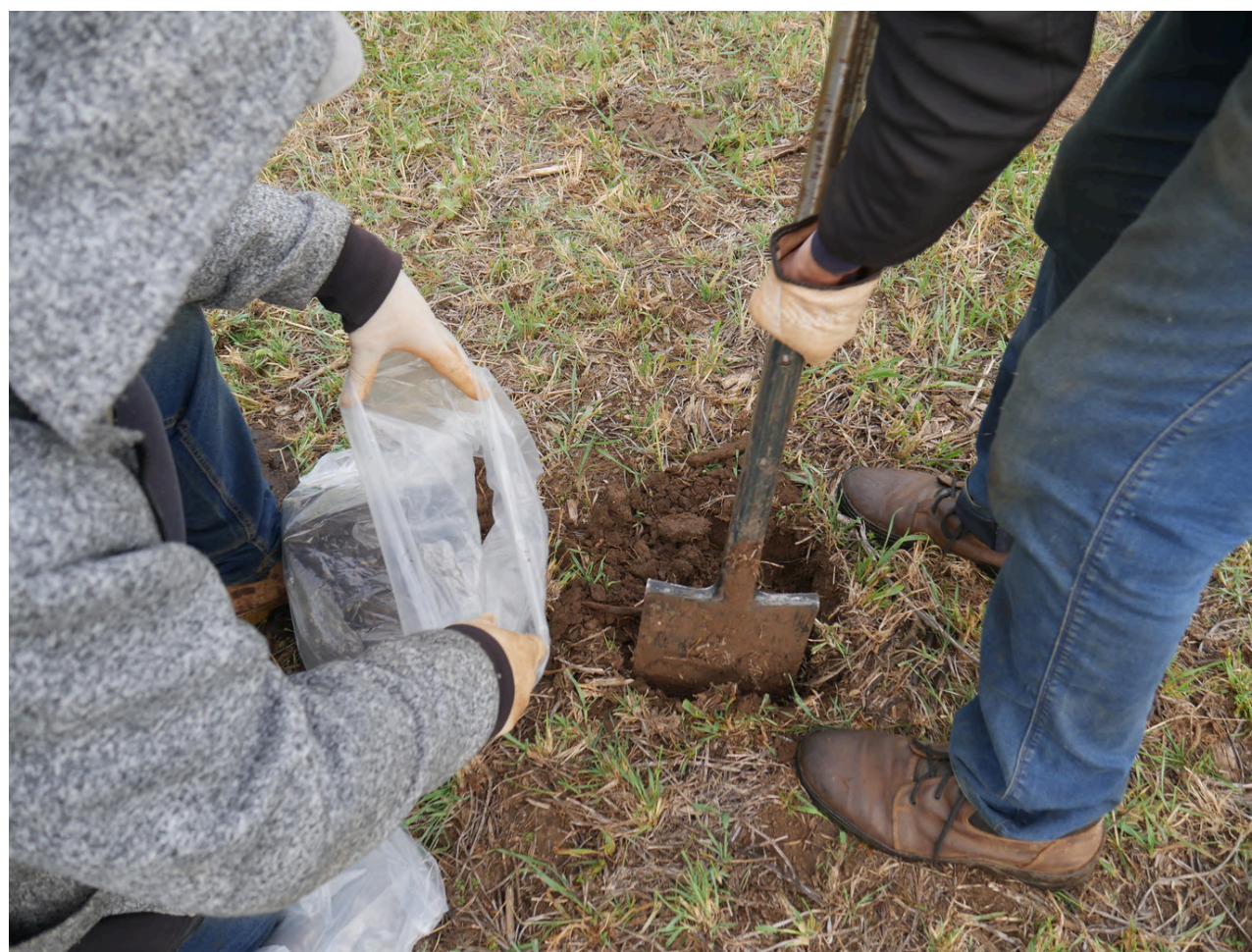
Figura 7. Coleta do monólito sem a escavação da trincheira. Foto: Marie Bartz.
