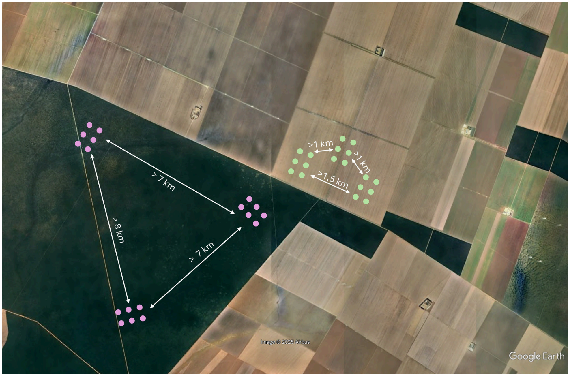
Figura 2. Exemplo de distribuição espacial e número de amostras a serem coletadas em áreas de larga escala. Imagem: Google Earth.
