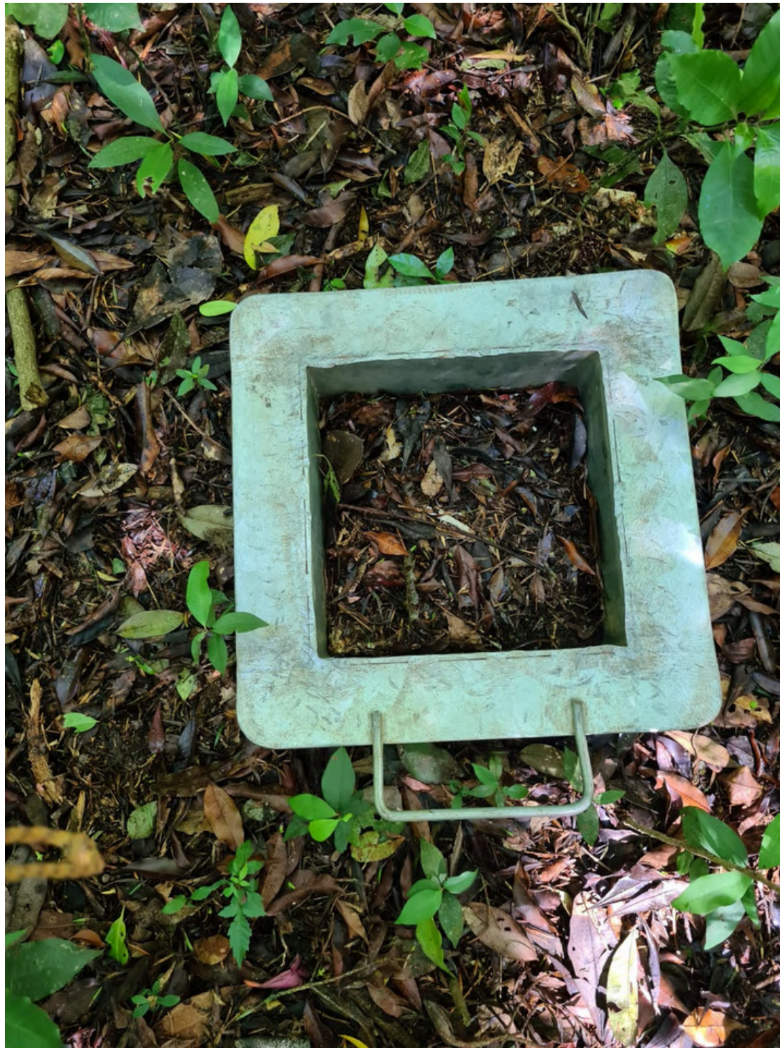
Figura 6. Gabarito de metal para coleta da macrofauna do solo até 10 cm profundidade usando o método TSBF. Foto: George Brown.
