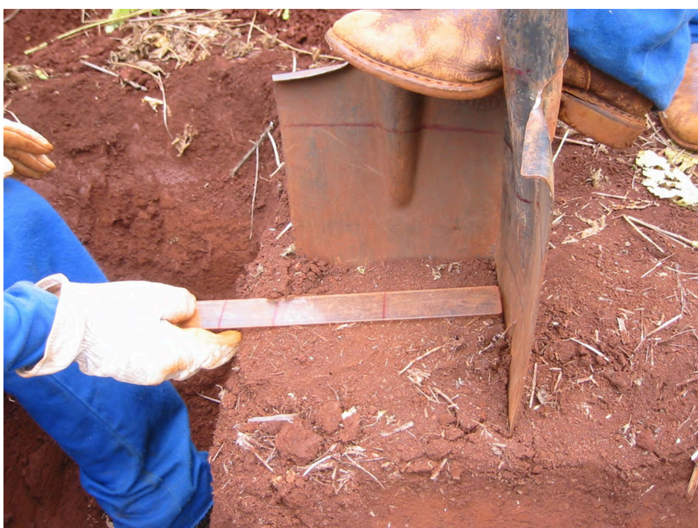
Figura 5. Retirada das camadas de solo de 10 cm usando o método da mini-trincheira. Foto: George Brown.
